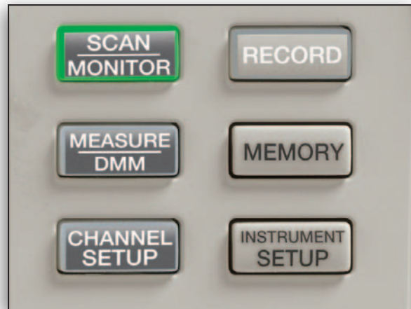
Funktionstasten an der Vorderseite zum Scannen, Überwachen, Messen und für den Einsatz als Multimeter.
